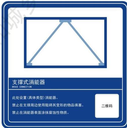
图 5.1.2-3 支撑式消能器标识
