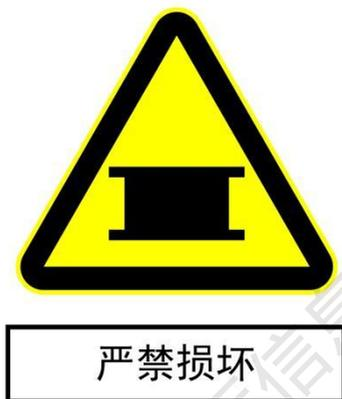
图 5.2.2-4 隔震支座警示标识
