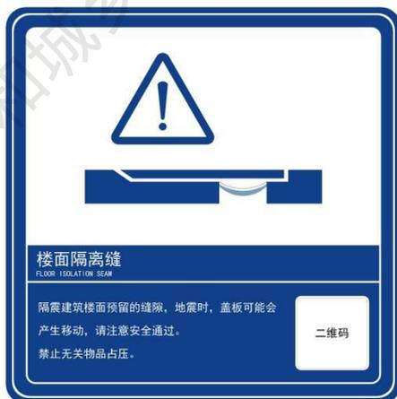
图 5.1.3-7 楼面隔离缝标识
