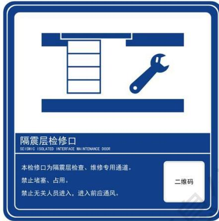
图 5.1.3-4 防震层检修口标识
