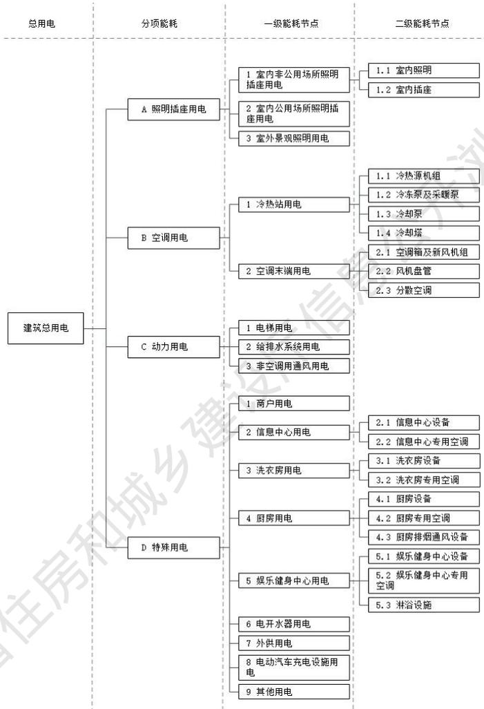
附图 A.0.1 用电分项计量结构图
